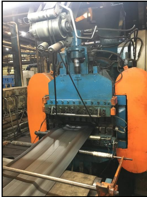
Gambar 4.6 Proses Pembuatan Tread Mesin Extruder (Sumber : PT XYZ, 2019)
