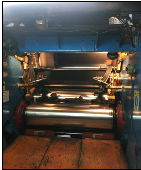
Gambar 4.3 Pembuatan treatment ( Topping Calender ) (Sumber : PT XYZ, 2019)
