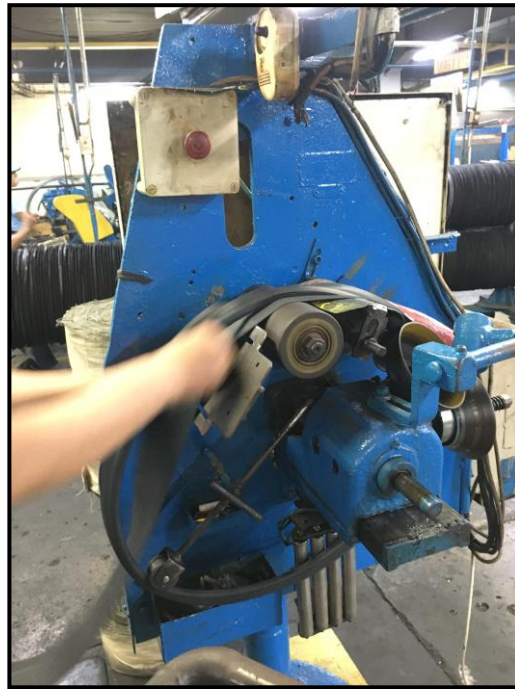
Gambar 4.7 Proses Bead Grommet (Sumber : PT XYZ, 2019)
