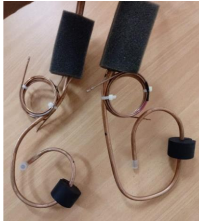
Gambar 1. Damper Pipe pada pipa kompresor
